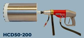
Der HCD 50-200 läuft mit einer Drehzahl von 600 l/min und ist für Kernbohrungen Ø50-60 mm sowie für handgeführte Bohrungen bis zu Ø350 mm ausgelegt. Damit passt er perfekt zum Bohren von Löchern für die Verlegung von Kabeln bzw. von Bohrung mit großem Durchmesser auf engstem Raum. Weitere Einsatzmöglichkeiten sind Abwasserleitungen oder anspruchsvolle Unterwasserarbeiten.
