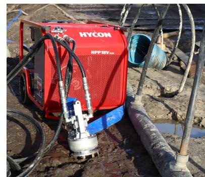
Ein Ansaugen ist nicht erforderlich. Der hydraulische Direktantrieb sichert, dass die Pumpe trocken laufen kann, ohne Schaden zu nehmen. Perfekt für Förderaufgaben, bei denen Wasser bzw. Abwasser nicht kontinuierlich zugeführt wird
